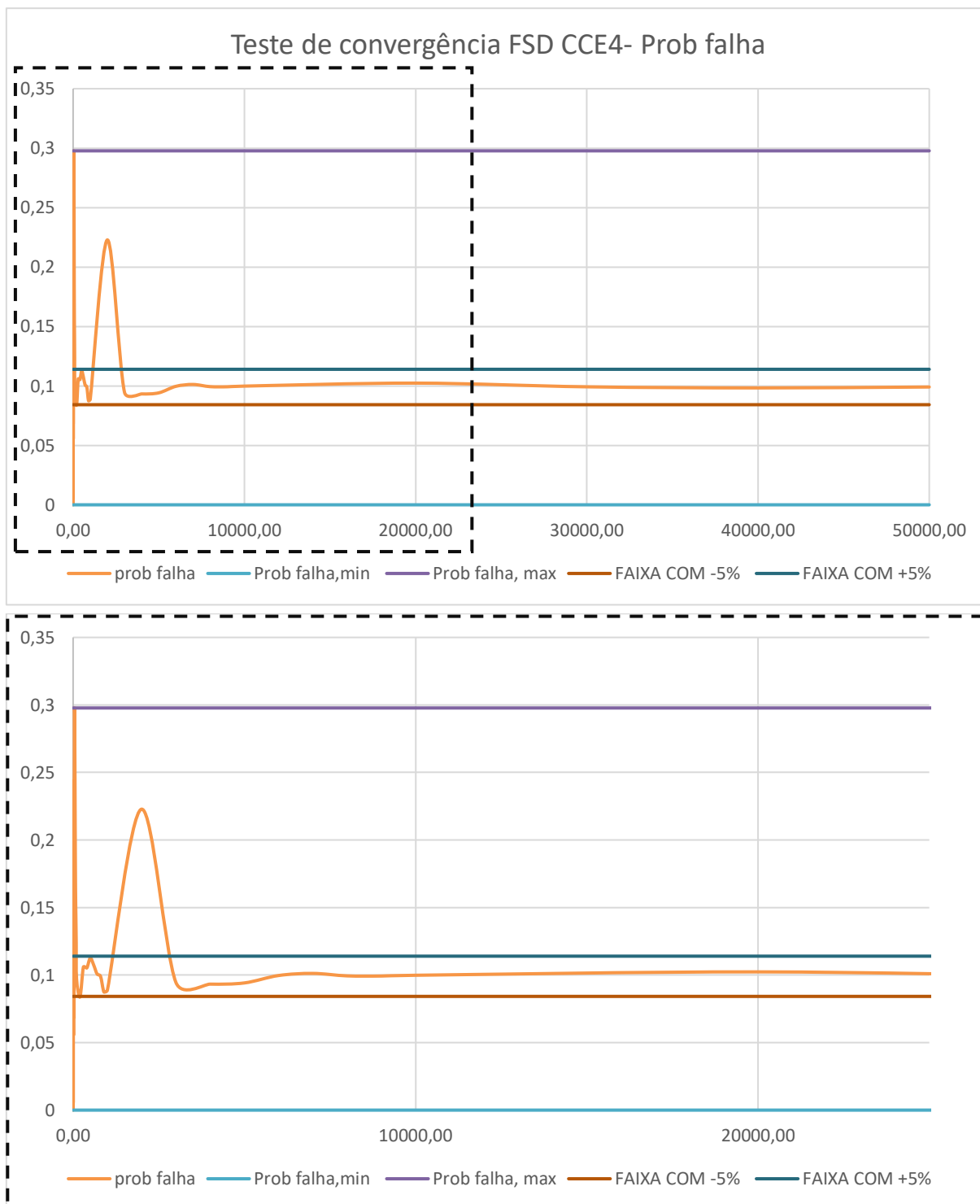
Gráfico 5 –Convergência dos métodos de Monte Carlo para o FSDprob-CCE-4 por meio da Probabilidade de falha
