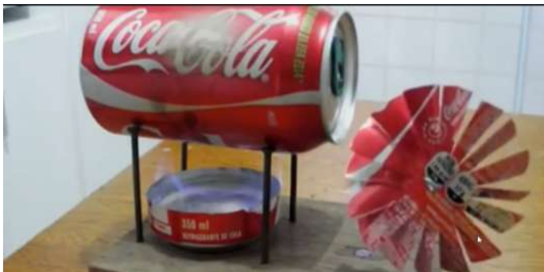
Figura 4: Máquina térmica construída com materiais de baixo custo. Fonte: Banco de imagens do autor.
