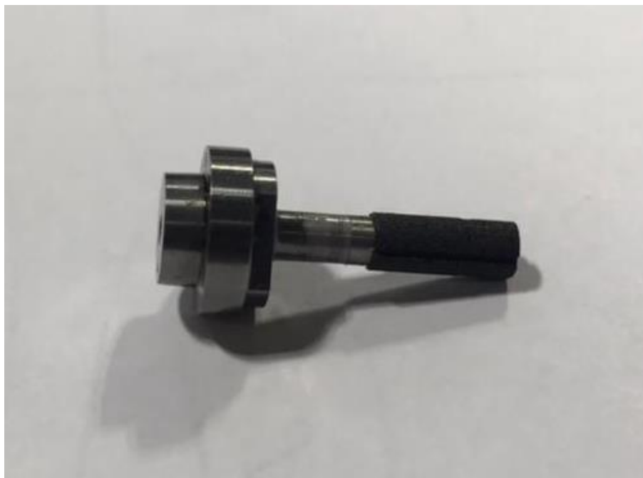
Figura 16 - Rebolo de cBN (VBF 400 K 195 KCP3M VFCP)
