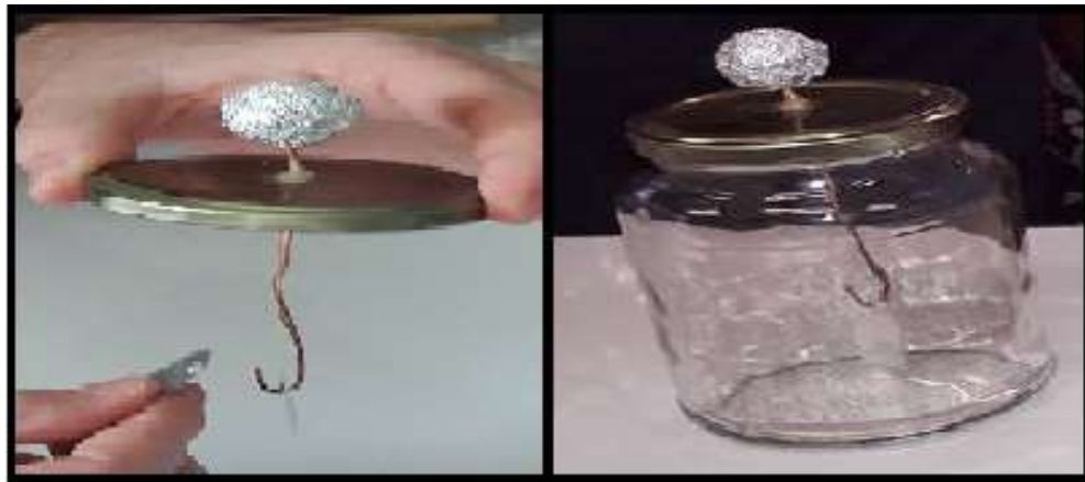
Figura 8 – Cortando as folhas de papel alumínio e finalizando o eletroscópio. Fonte: Acervo do pesquisador.
