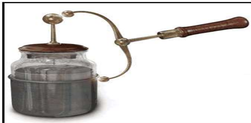
Figura 6 - Imagem de uma garrafa de Leyden Fonte: http://www.geocities.ws/saladefisica5/leituras/leyden.html .
