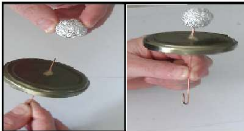
Figura 6 – Encaixando a bolinha de papel alumínio. Fonte: Acervo do pesquisador.
