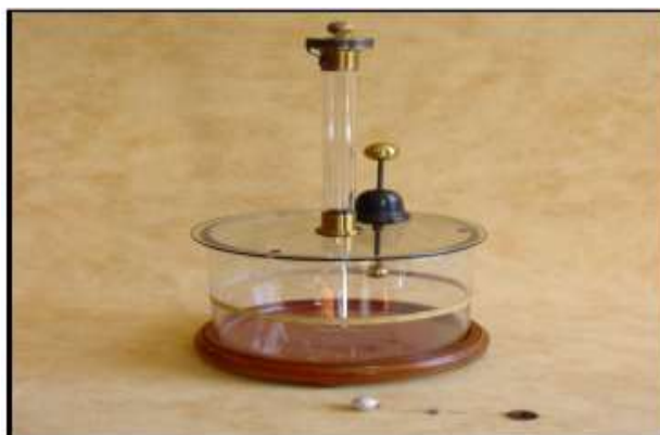
Figura 8 - Imagem de uma balança de torção Fonte: Kazuhito, Fuke, 2010, p. 33.
