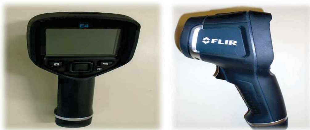
Figura 6 – Aparelho de análise termográfica
