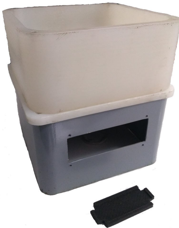
Figura 50 - Carenagem mecânica e suporte da lâmina as-built
