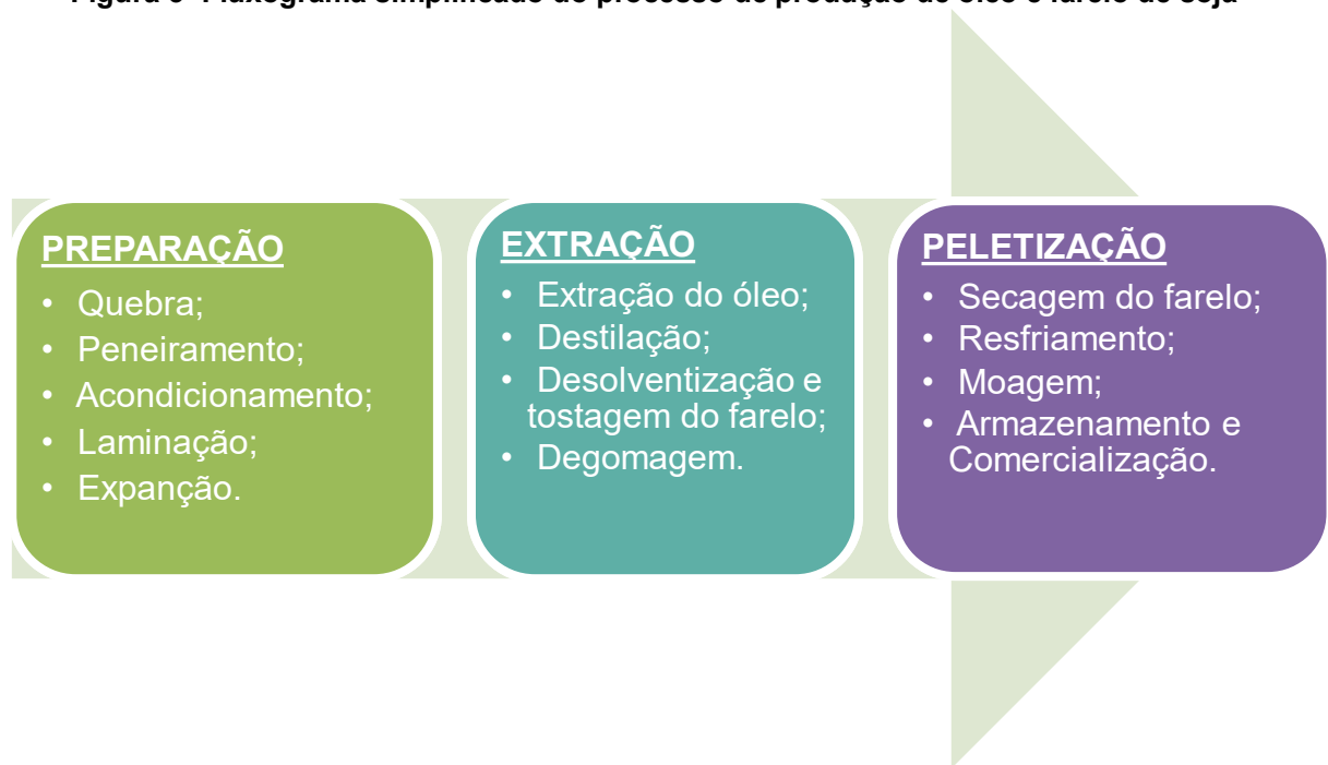
Figura 3- Fluxograma simplificado do processo de produção de óleo e farelo de soja
