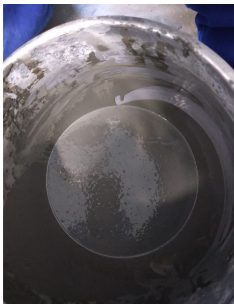
Figura 24 - Ensaio de empacotamento úmido - pasta com 15% de sílica, a/agl = 0,18 e teor médio de aditivo de 3,3%
