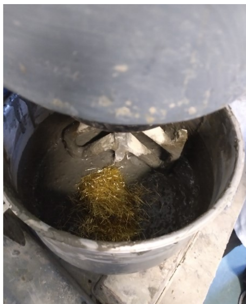
Figura 36 - Adição de fibras
