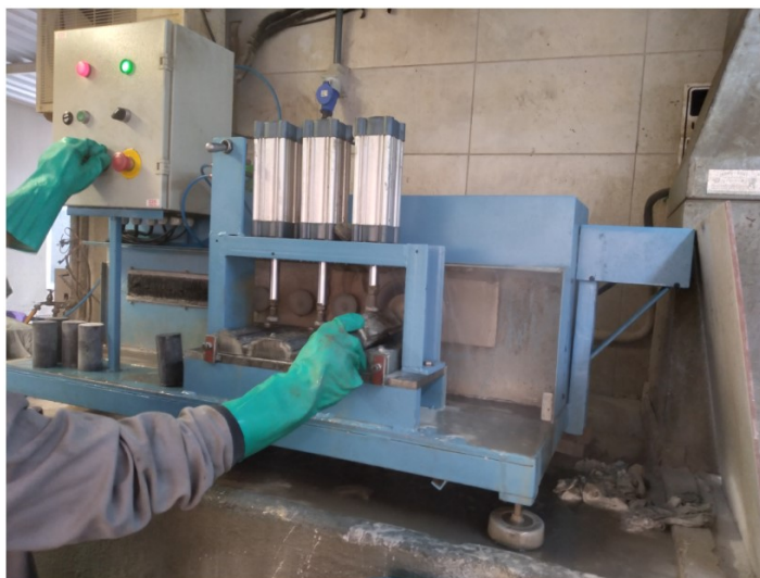
Figura 40 - Procedimento de retífica
