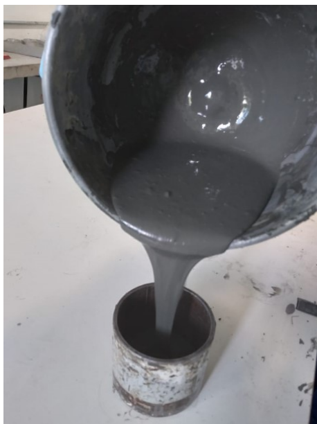
Figura 34 - Fluidez da pasta para a relação a/agl de 0,16
