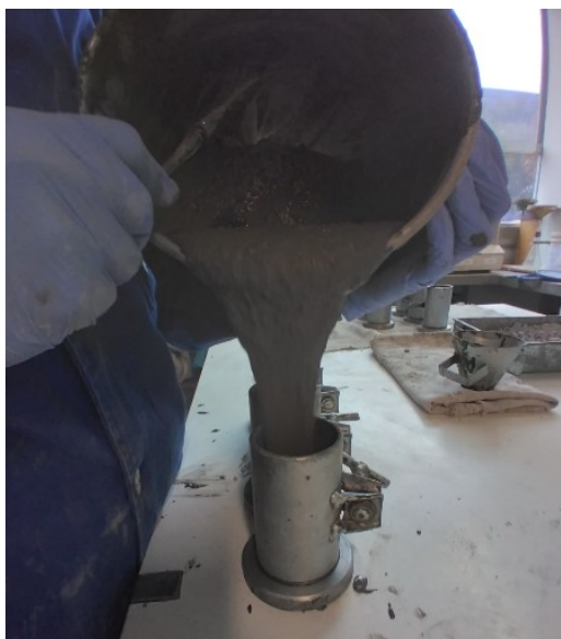
Figura 45 - Característica autoadensável do traço com 20% de sílica e 80% de volume adicional de pasta
