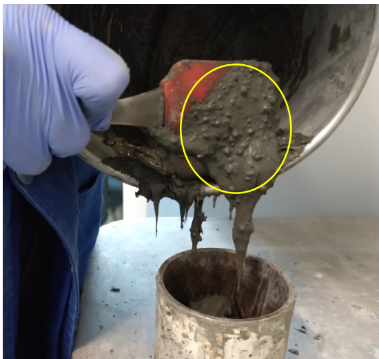
Figura 25 - Ensaio de empacotamento úmido - pasta com 30% de sílica, a/agl = 0,16 e teor médio de aditivo de 3,3%
