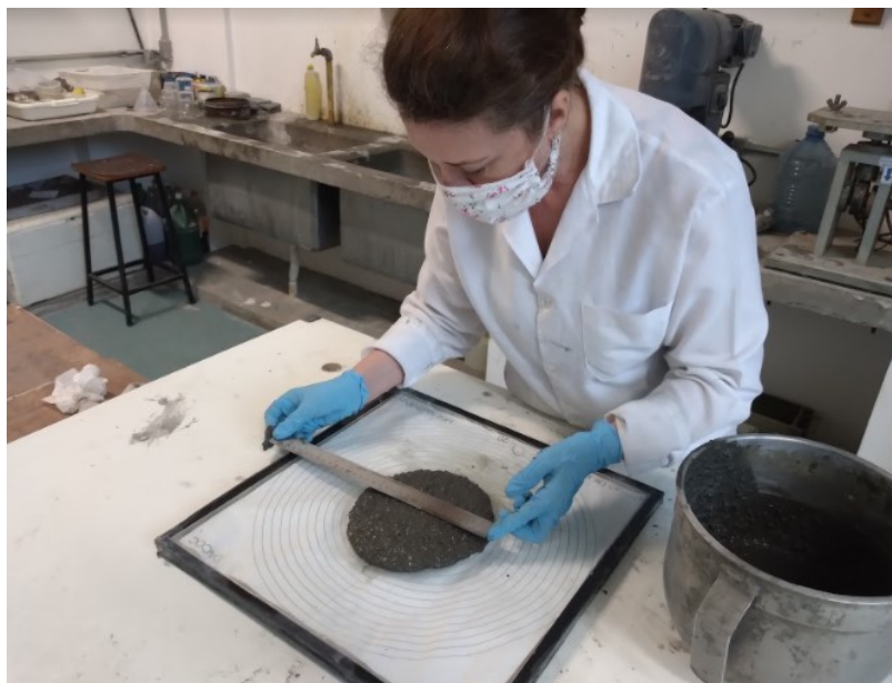
Figura 39 - Determinação do diâmetro da pasta
