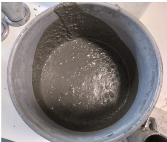
Figura 67 - Traço piloto para q = 0,22 e a/agl = 0,20 com o teor de aditivo ajustado
