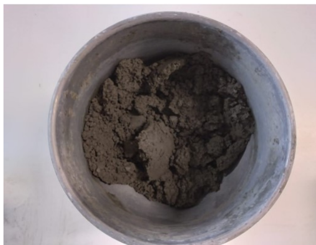
Figura 66 - Traço piloto para q = 0,22 e a/agl = 0,20
