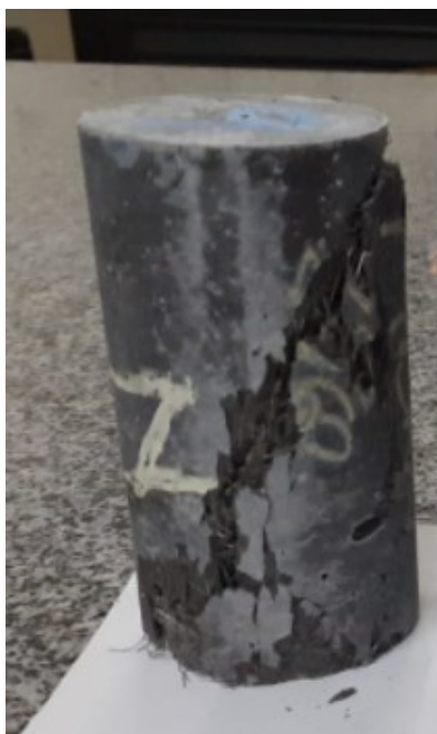
Figura 56 - Padrão de fratura das amostras com adição de fibras
