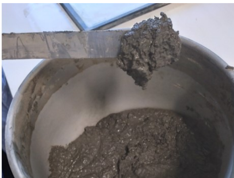
Figura 37 - Fluidez do traço com o mínimo volume de pasta
