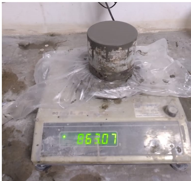
Figura 26 - Ensaio de empacotamento úmido - determinação da massa de material
