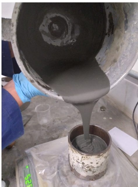
Figura 22 - Ponto de liquefação da pasta (relação a/agl = 0,12)
