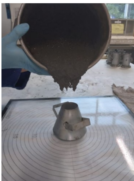
Figura 38 - Ensaio de determinação da fluidez da pasta
