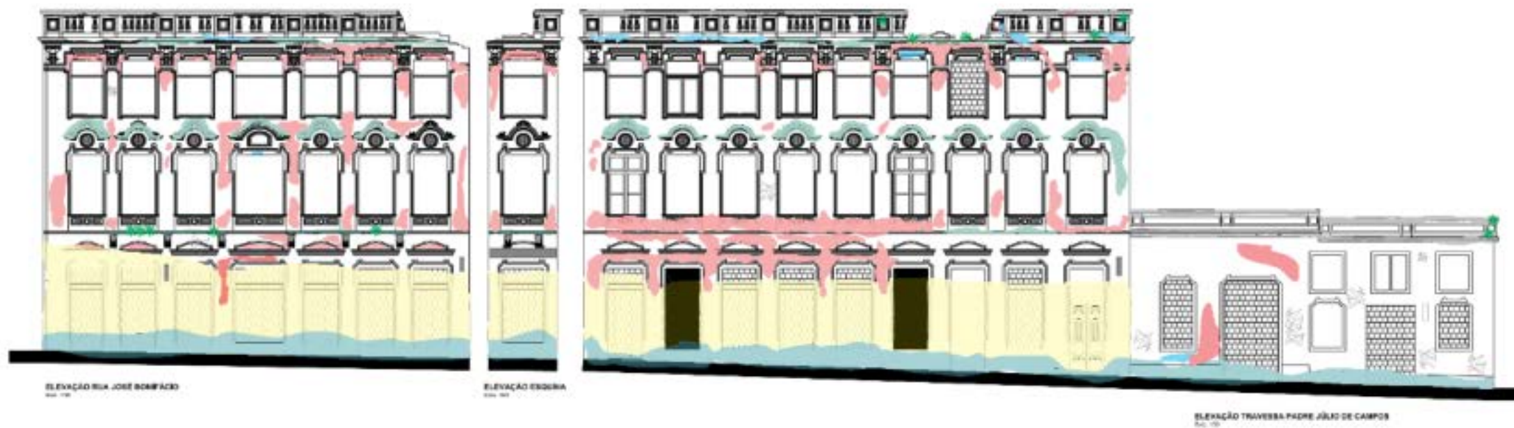
Forma 68: Mapeamento de danos – Ferragens Hauer Fonte: Autor.
