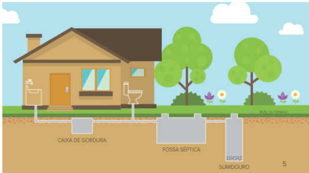
Figura 07 - Sistema individual para destinação do esgoto doméstico
