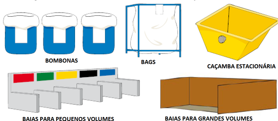
Figura 5 - Acondicionamento dos resíduos de construção no canteiro de obras
