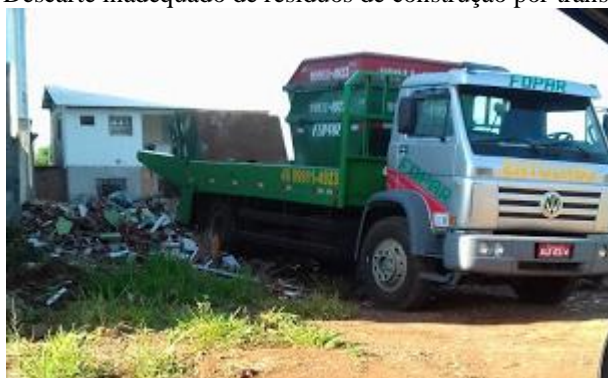
Figura 32 – Descarte inadequado de resíduos de construção por transporte privado
