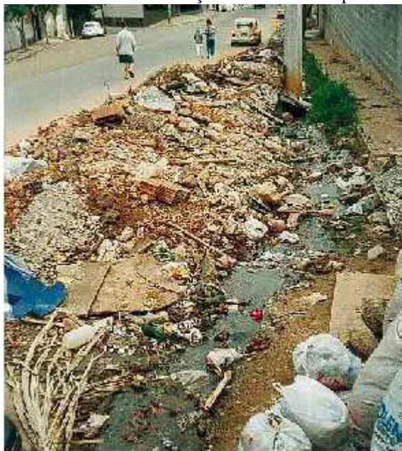
Figura 2 – Disposição irregular de resíduos de construção obstruindo vias públicas e a rede de drenagem urbana
