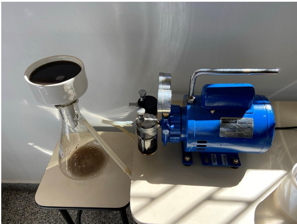
Imagem 4 - Esquema de filtração após o segundo tratamento do efluente.
