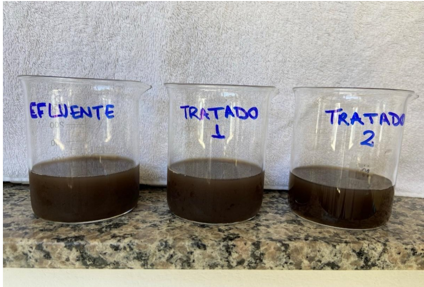
Imagem 9 - Cor do efluente antes, entre e após tratamento
