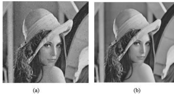
Figura 4: Imagem original (a); Imagem processada com filtro de mediana (b). Fonte:(PFLEGER, 2016).
