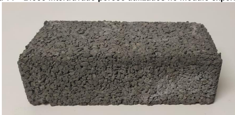
Figura 14 – Bloco intertravado poroso utilizados no módulo experimental
