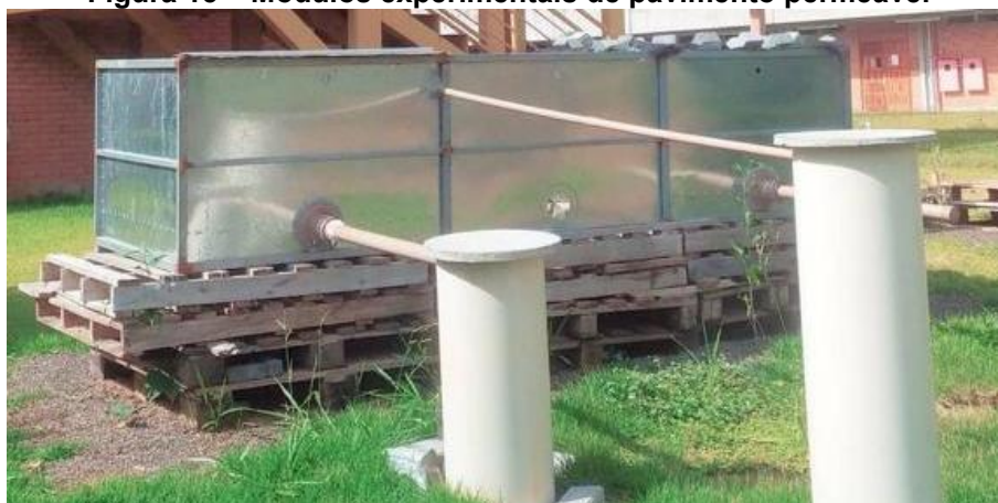
Figura 15 – Módulos experimentais de pavimento permeável
