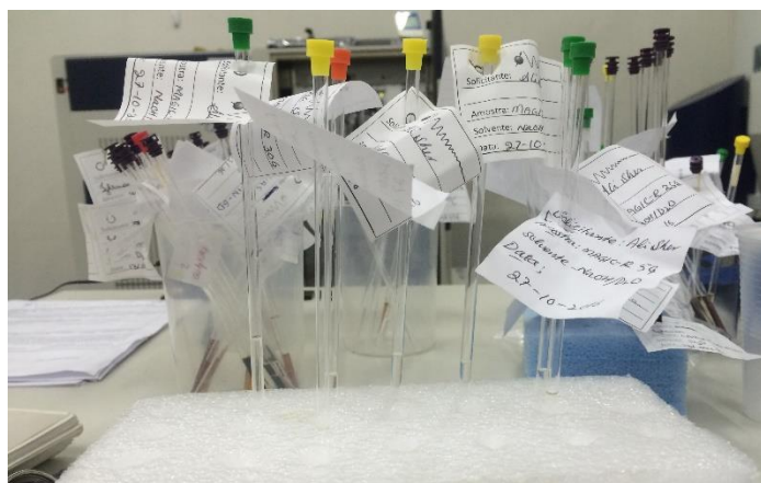
Figura 23: Cubetas próprias para análise do gel MAGIC-f com RMN. Fonte: Autoria Própria.
