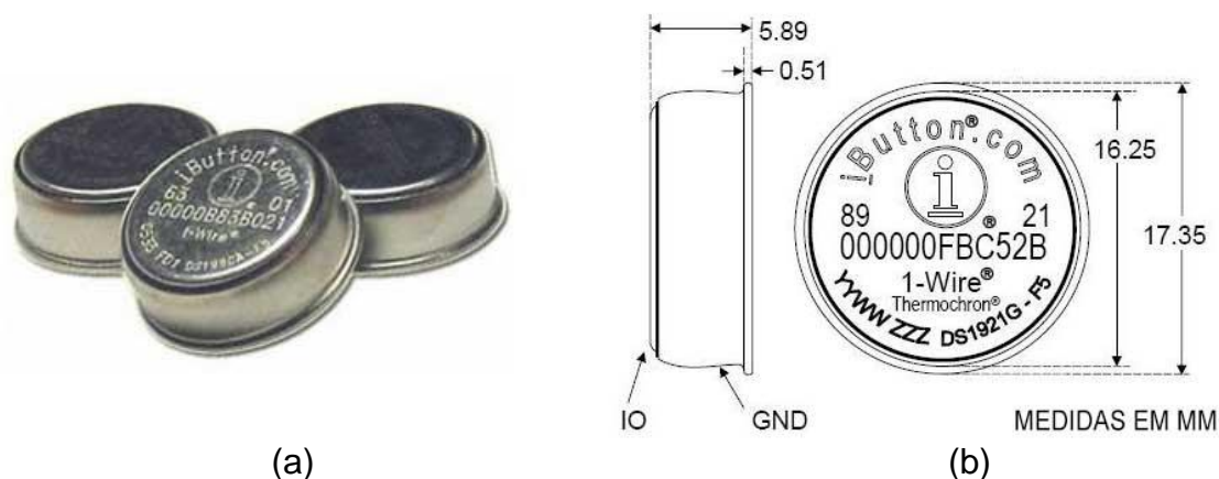
FIGURA 28 - (A) IBUTTON MODELO DS1921H-F5; (B) DESENHO TÉCNICO COM MEDIDAS GERAIS DO EQUIPAMENTO
