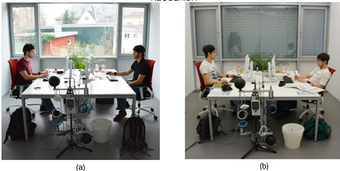
FIGURA 33 - (A) JANELAS CERRADAS, ILUMINAÇÃO NATURAL E PERSIANA EXTERNA ABAIXADA; (B) JANELAS CERRADAS, ILUMINAÇÃO ELÉTRICA E PERSIANA EXTERNA RECOLHIDA
