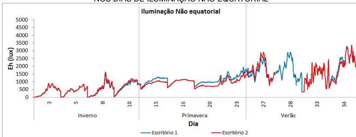
FIGURA 44 - VALORES DE E_H PARA OS ESCRITÓRIOS 1 E 2 AO LONGO DOS DIAS DE TESTE NOS DIAS DE ILUMINAÇÃO NÃO EQUATORIAL
