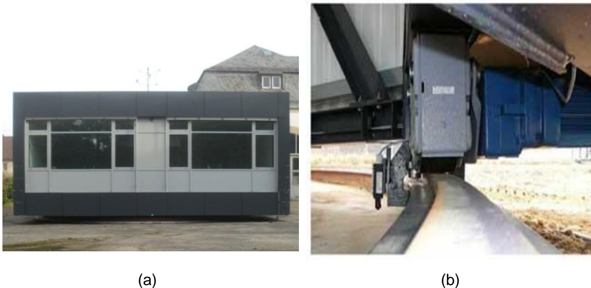
FIGURA 22 - (A) VISTA GERAL DA FACHADA ENVIDRAÇADA DO LOBSTER COM O SISTEMA DE PERSIANAS EXTERNAS E (B) TRILHO CIRCULAR NA BASE DA CÂMARA CLIMÁTICA
