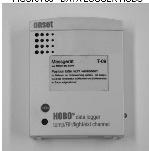
FIGURA 35 - DATA LOGGER HOBO
