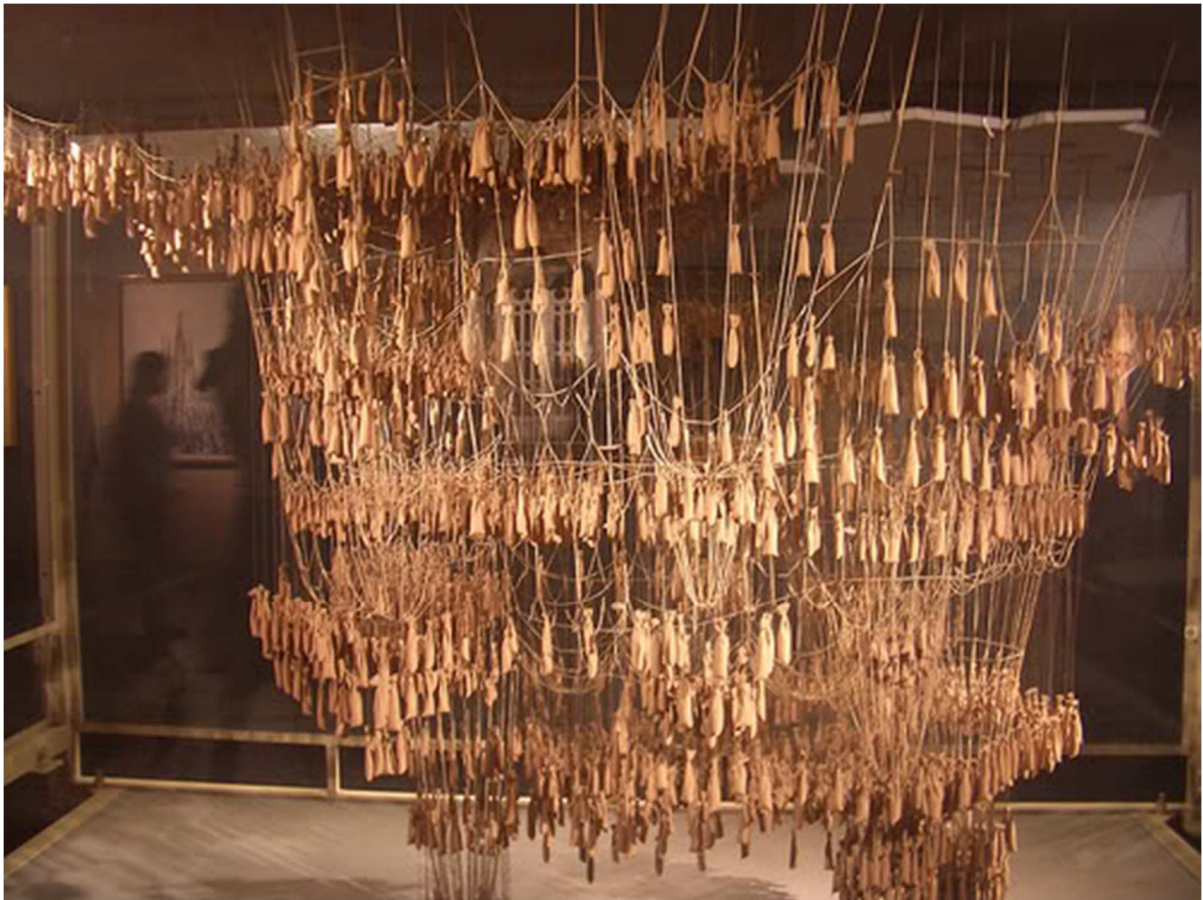
FIGURA 6: Modelo de correntes penduradas de Antoni Galdí com aplicação de cargas. Fonte: NÃO TRIVIAL
