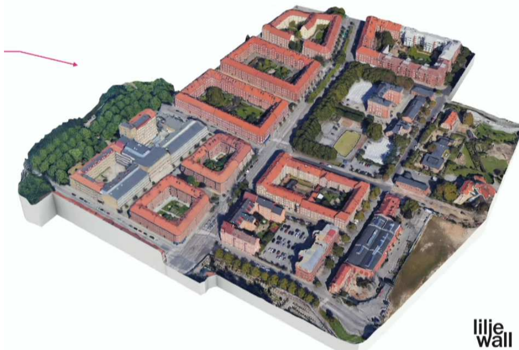
FIGURA 16: Maquete desenvolvida a partir de dados do Google Maps criada digitalmente através de scripts Python no software RHINOCEROS. Fonte: LILJEWALL ARKITEKTER.
