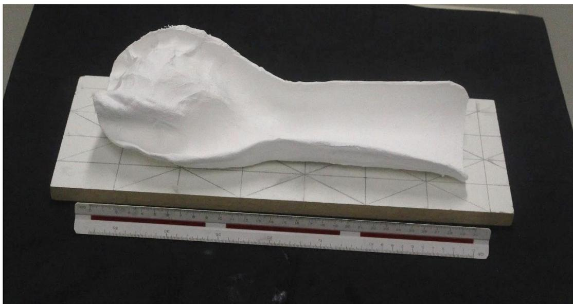
**Figura 39: Molde em atadura gessada fixado sobre base com marcadores visuais**
