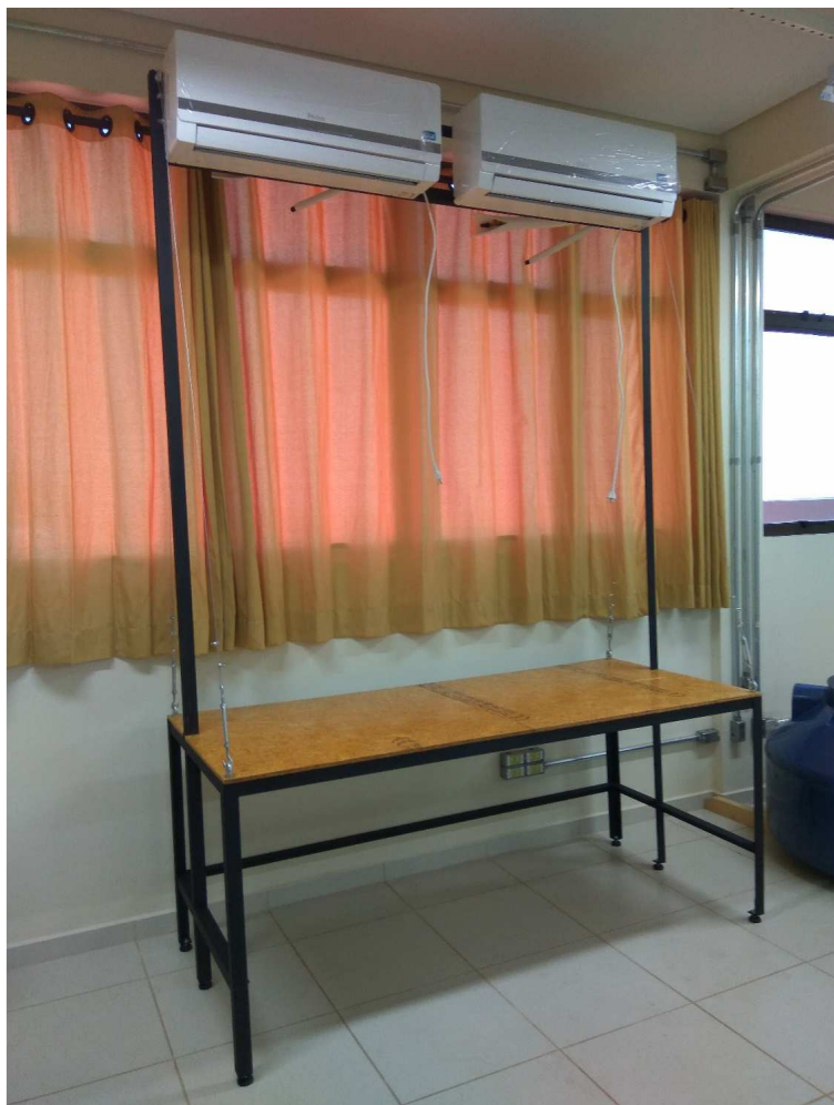
Figura 4 - Bancada experimental após construção.
