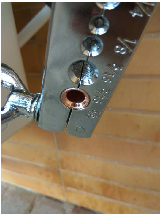
a) Flangeamento da tubulação de cobre.
