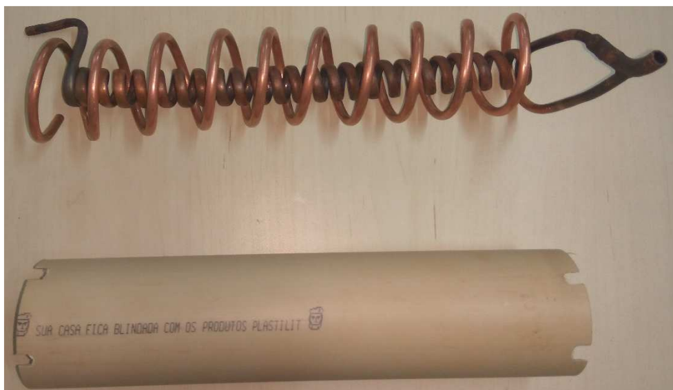
Figura 11 - Trocador de calor em fase de montagem.
