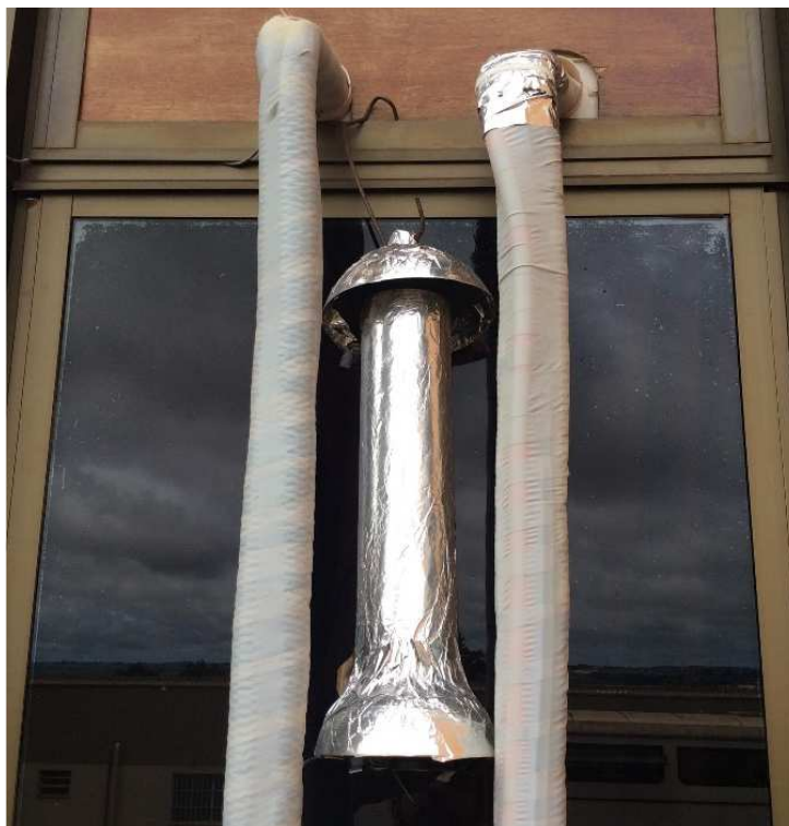
Figura 8 - Suporte utilizado para medição da temperatura ambiente.
