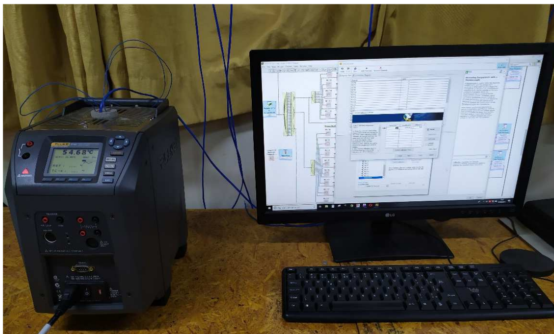
Figura 7 - Aparato de calibração dos termopares.
