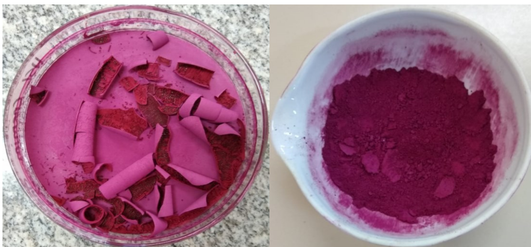
Figura 7. Corante híbrido (HNZ-carmim) a) após secagem e b) após moagem
