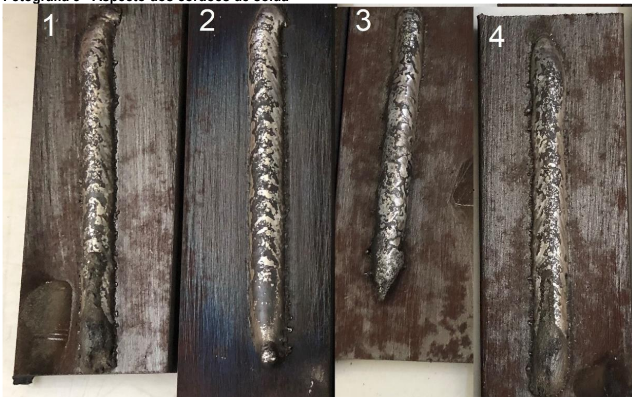
Fotografia 3 - Aspecto dos cordões de solda
