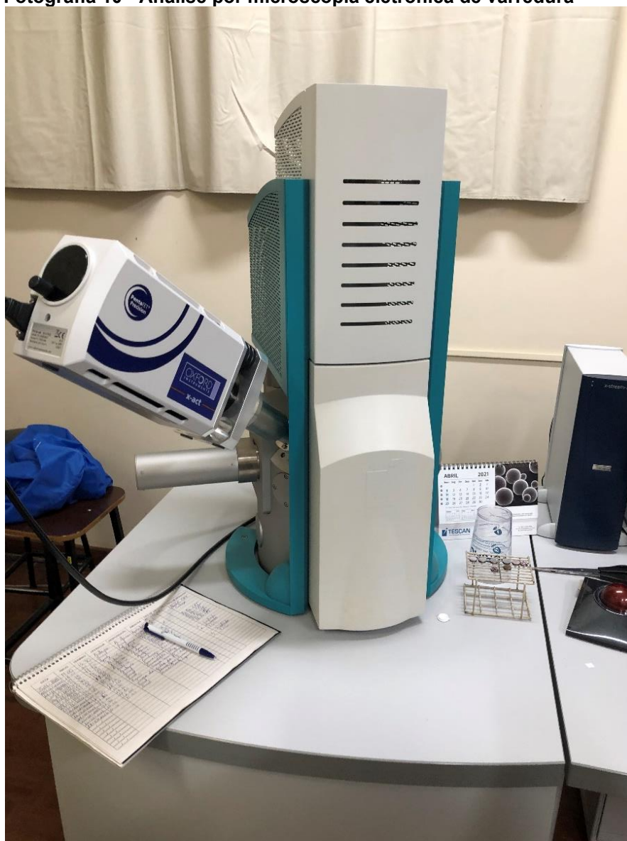
Fotografia 10 - Análise por microscopia eletrônica de varredura
