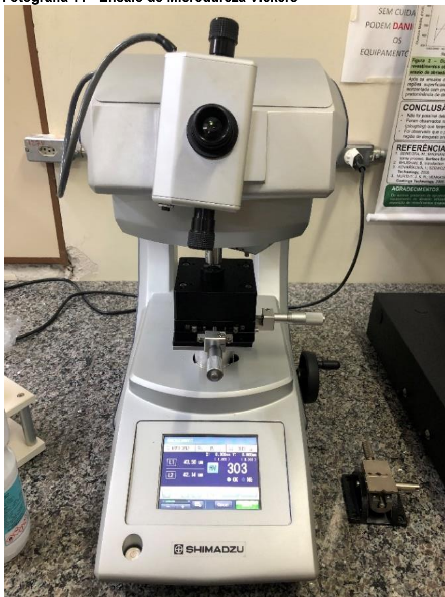
Fotografia 11 - Ensaio de Microdureza Vickers
