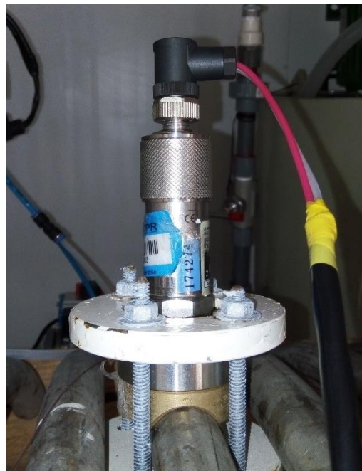
Figura 3.7 - Transdutor de pressão P-31 na tomada de pressão P2.
