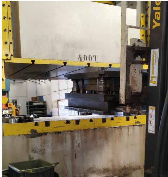
Figura 5 - Empilhadeira posicionando a ferramenta Fonte: Autoria própria com autorização da empresa, 2019.
