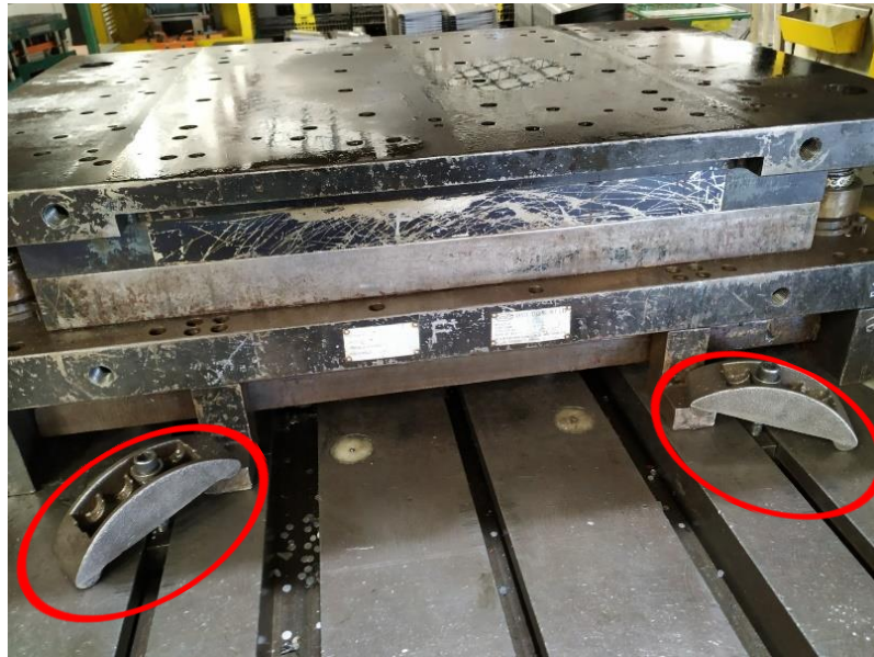
Figura 3 – Presilhas de fixação da matriz à mesa da prensa Fonte: Autoria própria, 2019.
