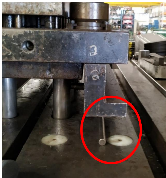
Figura 7 - Barras de ferro utilizadas para posicionamento de ferramenta lateral Fonte: Autoria própria com autorização da empresa, 2019.
