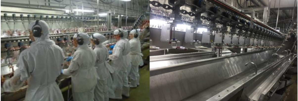
Figura 6 - Empregados realizando a retirada de coração / calha Fonte: Autoria própria
