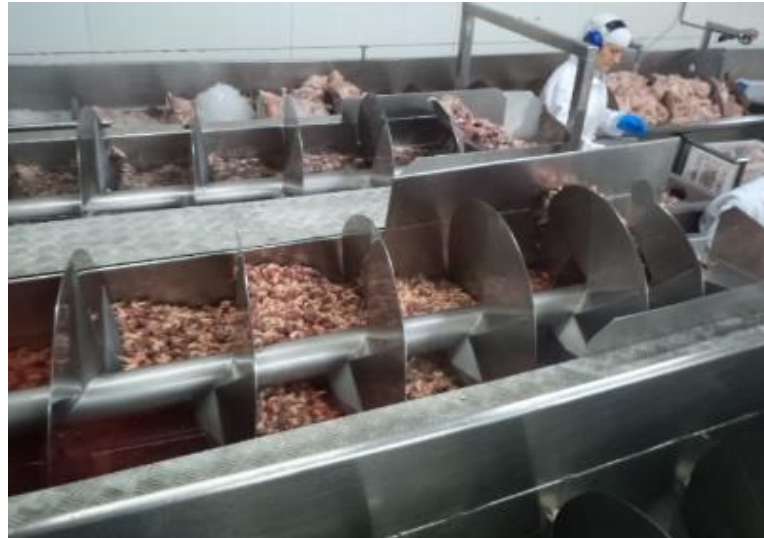
Figura 15 - Corações acima do nível de água do chiller Fonte: Autoria própria.
