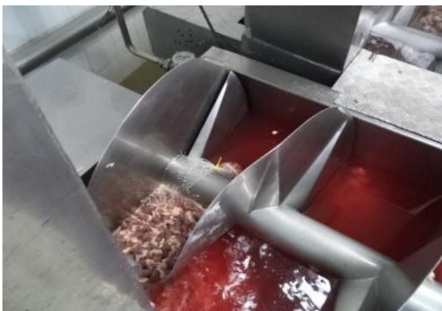
Figura 17 - Posicionamento dos corações no chiller no novo método Fonte: Autoria própria.
