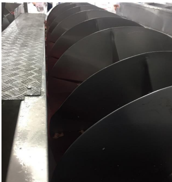
Figura 10 - Chiller de resfriamento de coração de frango Fonte: Autoria própria.
