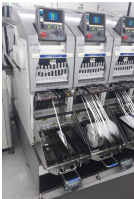
Figura 27 - Frente da máquina codificada com sistema Poka Yoke
