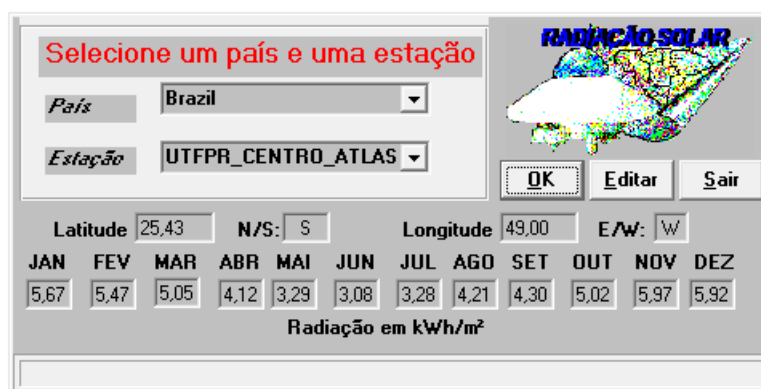
Figura 68 – Radiasol com Valores de Irradiação no Plano Horizontal da Sede Centro Fonte: Acervo da Autora.
