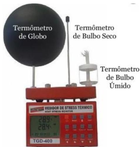
Figura 15 – Medidor de Stress Térmico
