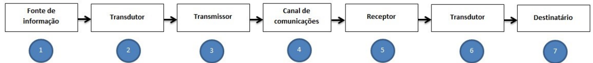
Figura 1 – Diagrama em blocos de um sistema de comunicações analógico Fonte: Princípios de Telecomunicações Teoria e Prática (2007, p. 21).
