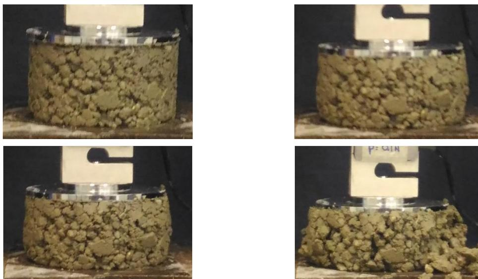
**Figura 41 - Evolução do ensaio *squeeze-flow* do concreto com teor de pré-molhagem de 75%**
