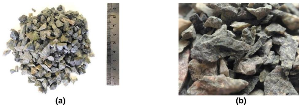
**Figura 31 - (a) Partículas do agregado gráúdo natural e (b) detalhe do formato das partículas.**
