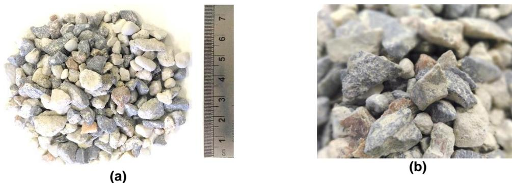
**Figura 33 - (a) Partículas do agregado graúdo ARC lavado e (b) detalhe do formato e menor capa de argamassa ao redor das partículas.**
