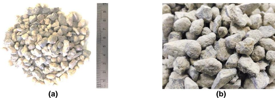
**Figura 32 - (a) Partículas do agregado gráúdo ARC peneirado e (b) detalhe do formato e capa de argamassa ao redor das partículas.**
