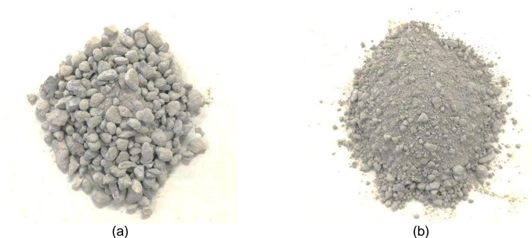
**Figura 14 - (a) Pedrisco e (b) areia reciclados de concreto**
