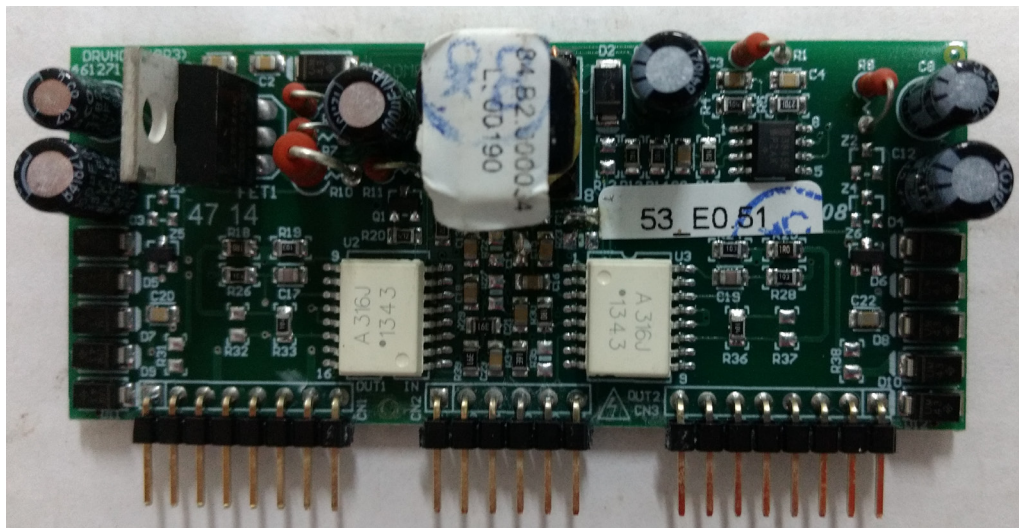
Figura 56 – Driver de Mosfet Utilizado Fonte: Foto Real do Driver
