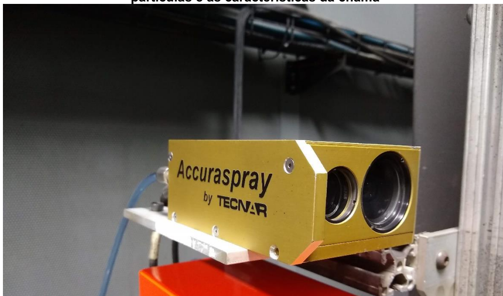
Figura 23 - Equipamento AccuraSpray utilizado para medição de temperatura, velocidade das partículas e as características da chama
