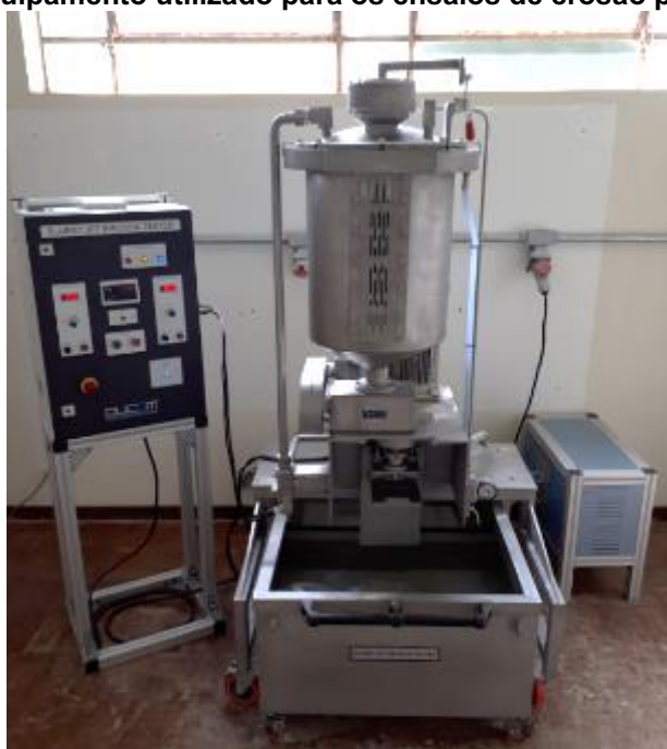
Figura 35 - Equipamento utilizado para os ensaios de erosão por jato de lama
