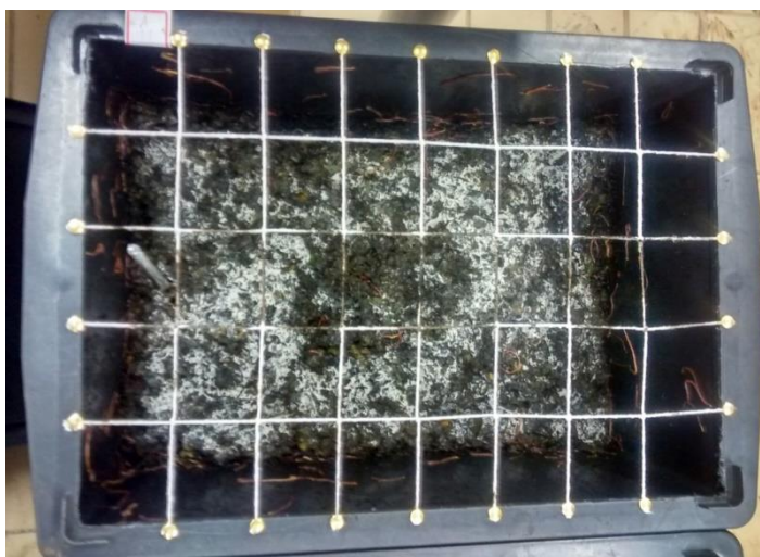
Figura 23: Amostrador desenvolvido pela pesquisadora para auxiliar na coleta de amostras nos vermidigestores. Fonte: Autoria própria.
