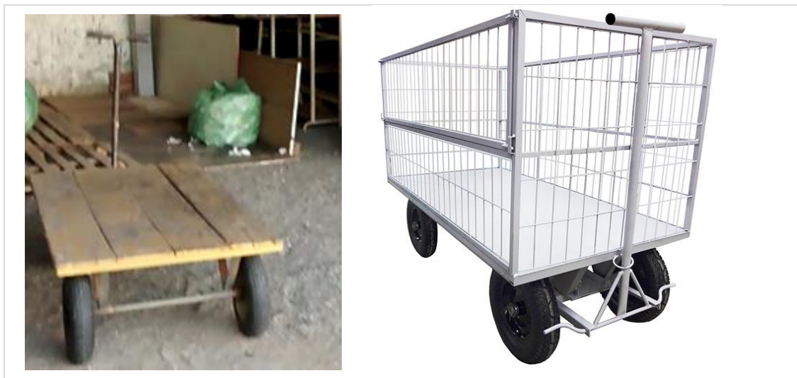
Figura 19: Carrinho para o de transporte de resíduos do RU. Foto do carrinho atual. B: Sugestão de carrinho de transporte de resíduos com grades e abertura lateral Fonte: Autoria própria; Cromo galvanizadora
