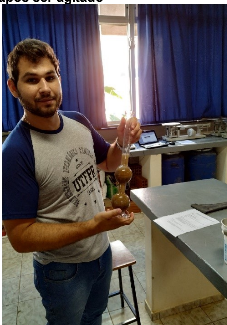
Foto 4 - Frasco de Chapman após ser agitado
