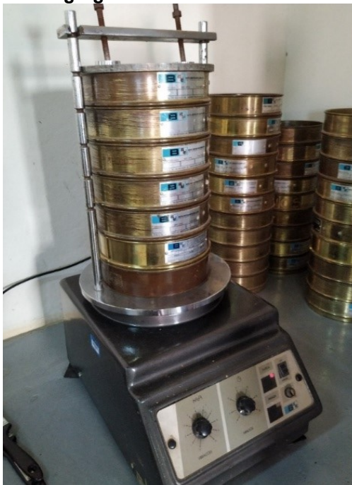
Foto 2 - Ensaio por peneiramento do agregado miúdo
