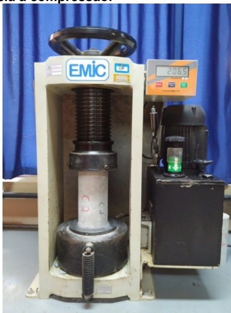
Foto 14 – Ensaio de resistência à compressão.
