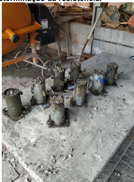
Foto 11 – Moldagem para a determinação da resistência.
