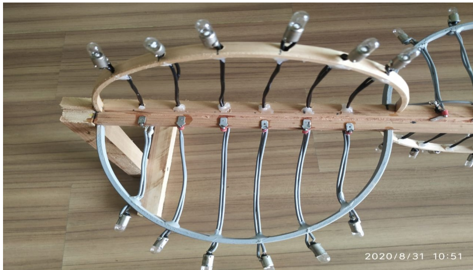
Figura 19: Maquete de representação de uma onda Eletromagnética
