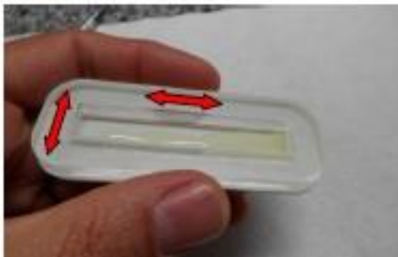
Figura 3.3 - Direções de inclinação do molde para uniformização das camadas. Fonte: Souza (2014)
