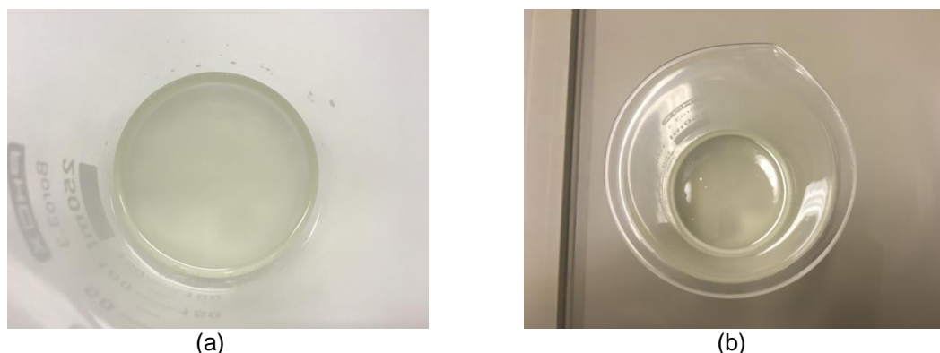
Figura 4.2 - (a) - Formulação com argila Cloisite 20® e (b) - Com argila BN-CT, sem formação do corpo de fundo. Fonte: O autor (2016)
