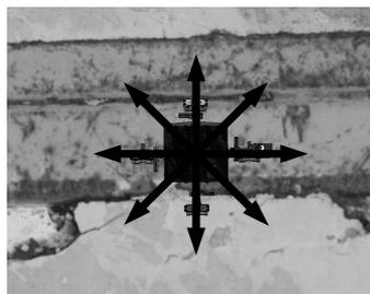
**Figura 3.3:** Direções dos movimentos (setas sobre o AIR-2) que podem ser realizadas pelo Controlador Fuzzy do Movimento Linear.
