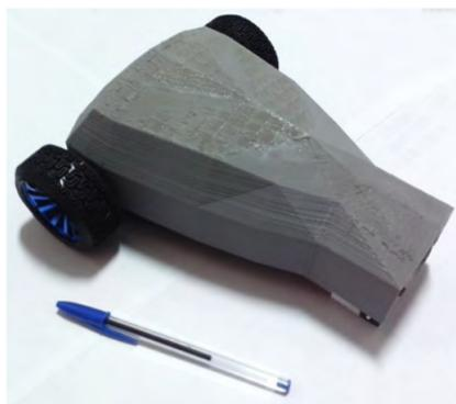
**Figura 2.4:** Robô escalador teleoperado.
