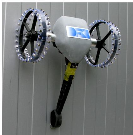
**Figura 2.2:** Robô escalador com mecanismo de adesão magnética para inspeção de embarcações marítimas.
