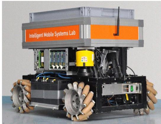
**Figura 1.3:** Robô omnidirecional de transporte de cargas.
