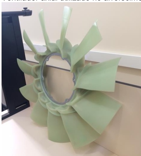
Fotografia 2 - Ventilador axial utilizado no arrefecimento do radiador
