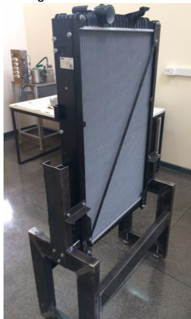
Fotografia 1 - Fotografia do radiador montado na bancada
