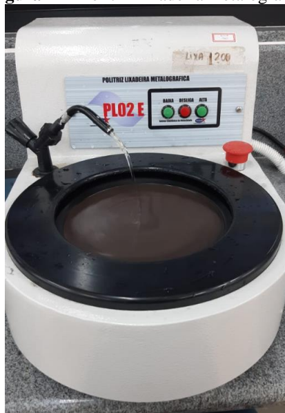
Figura 27 - Politriz lixadeira metalográfica
