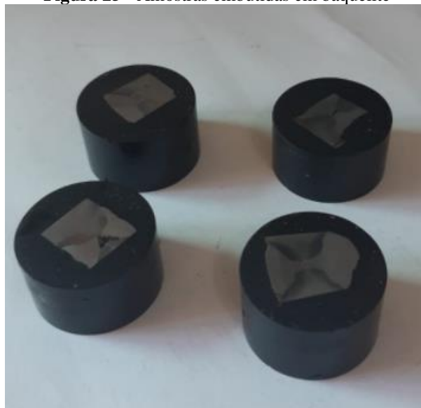
Figura 25 - Amostras embutidas em baquelite
