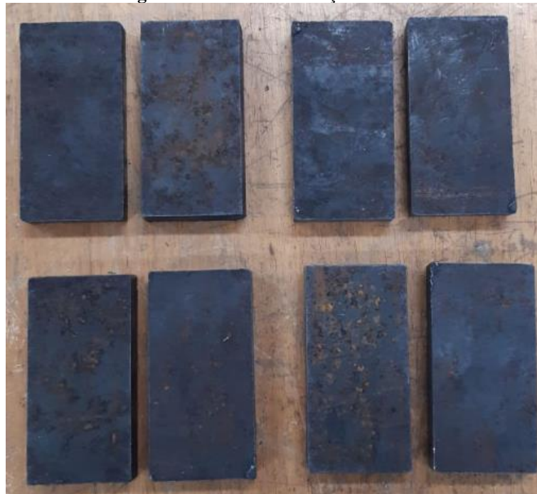
Figura 11 - Amostras de Aço SAE 1045
