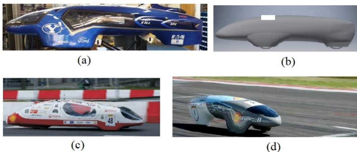
Figura 14 – Veículos usados como base para os Modelos 2 e 3. (a) BYU Supermileage (CD = 0.107); (b) Si Pitung G4 (CD = 0.13); (c) Eco-Arrow (CD = 0.096); Pac-Car II (CD = 0.075).
