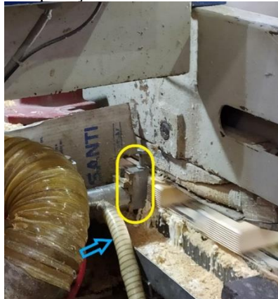
Figura 14 – Aplicação de adesivo em emendas dentadas
