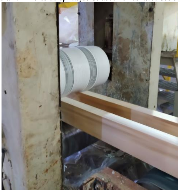
Figura 17 – Rolos de aplicação de adesivo nas faces dos blanks
