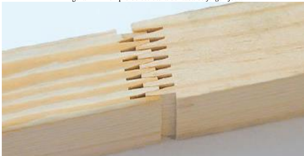
Figura 4 – Exemplo de estrutura dentada ou finger-joint
