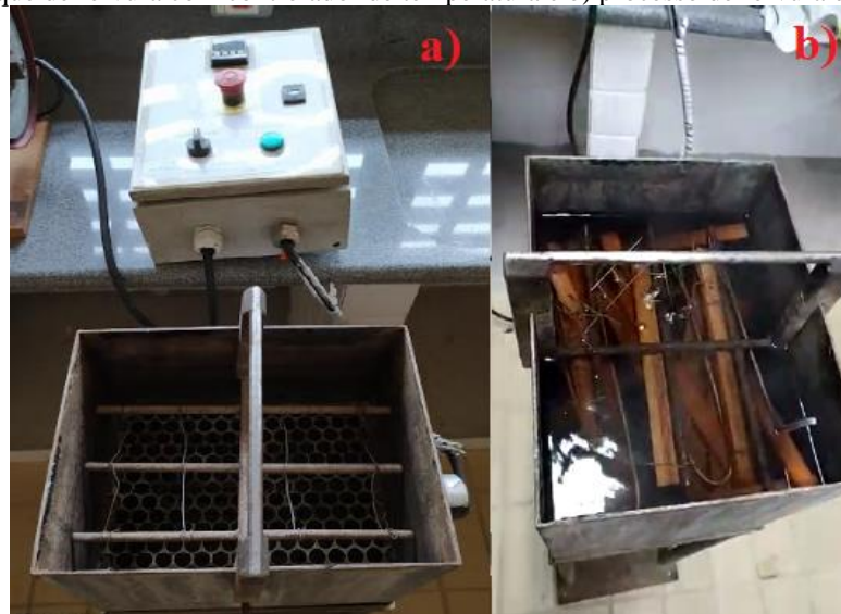
Figura 21 – a) Tanque de fervura com controlador de temperatura e b) processo de fervura de amostras de tração
