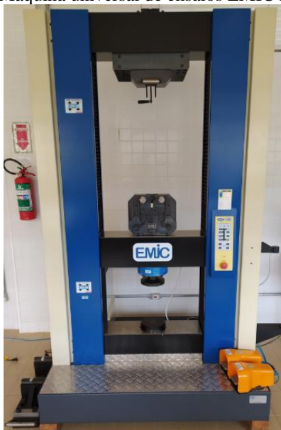
Figura 22 – Máquina universal de ensaios EMIC DL 30000 M.
