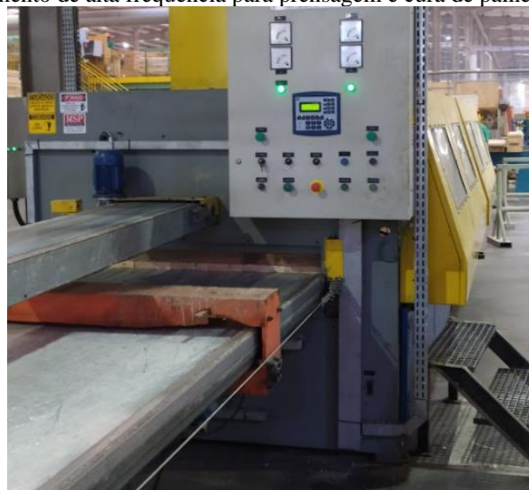
Figura 19 – Equipamento de alta frequência para prensagem e cura de painéis com adesivo PVAc
