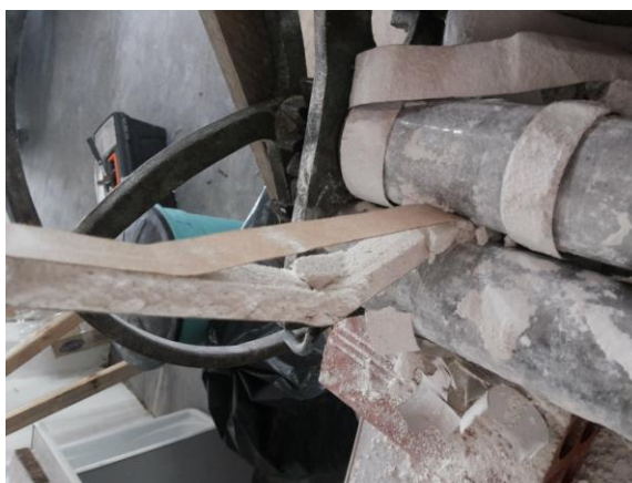
Figura 16 - Descolamento mecânico do cartão aderido no gesso após a passagem no cilindro manual
