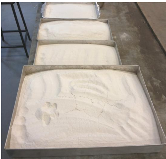
Figura 22 - Resíduo de gesso calcinado repousando para diminuição da temperatura
