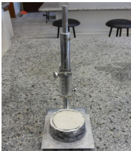
Figura 26 - Ensaio de tempo de pega do resíduo de gesso
