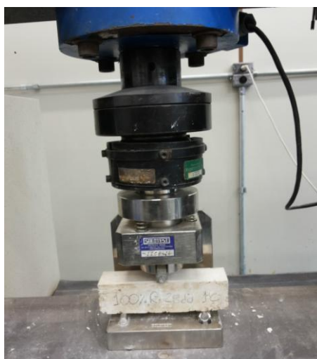
Figura 30 - Ensaio de tração na flexão realizado no corpo de prova prismático
