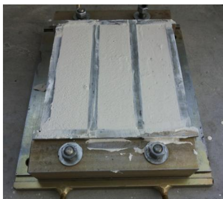
Figura 27 - Molde padronizado com dimensões 4 x 4 x 16 cm untado com cera
