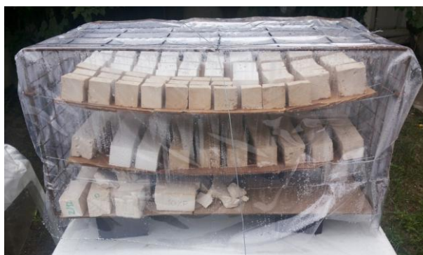
Figura 29 - Corpos de prova armazenados e identificados aguardando data para ensaio
