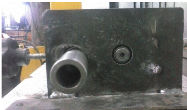
Figura 38 - Regulagem da distância entre os cilindros e rolamento livre blindado
