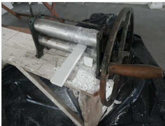
Figura 15 - Separação manual da massa de gesso do cartão
