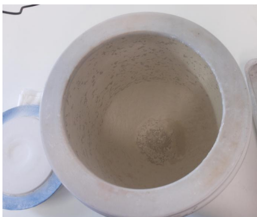
Figura 39 - Resíduo de gesso após a trituração no moinho de bolas
