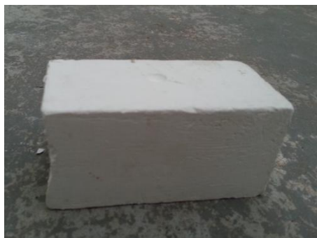
Figura 33 - Marca da esfera de aço do ensaio de dureza superficial sobre os corpos de prova.
