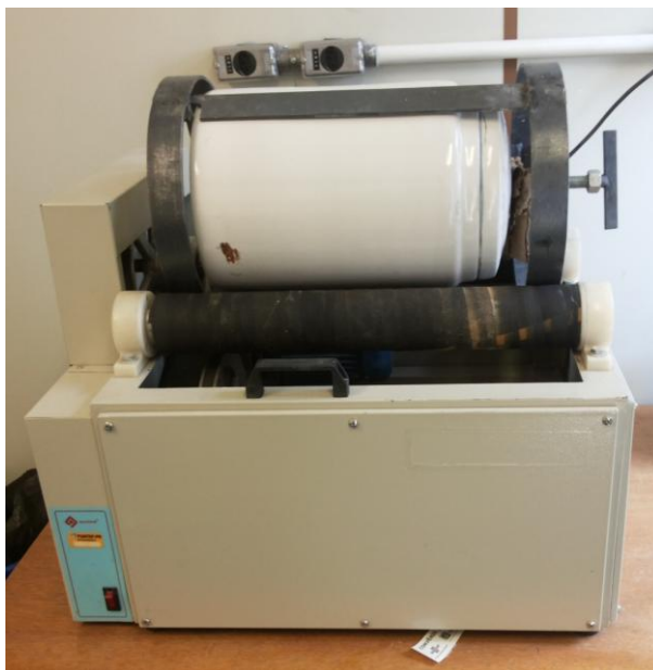
Figura 21 - Moinho de bolas de porcelana com esferas de ágata
