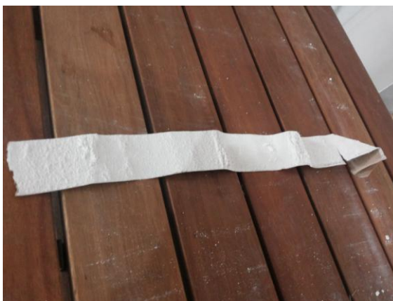
Figura 17 – Gesso aderido no papel cartão após a segunda passagem no cilindro manual
