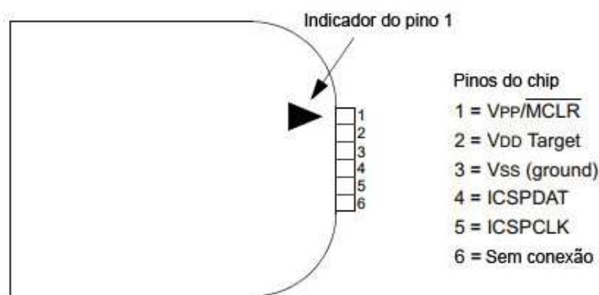
Figura 15 - Conexões para conectar o PicKit3 ao PIC16F1824.
