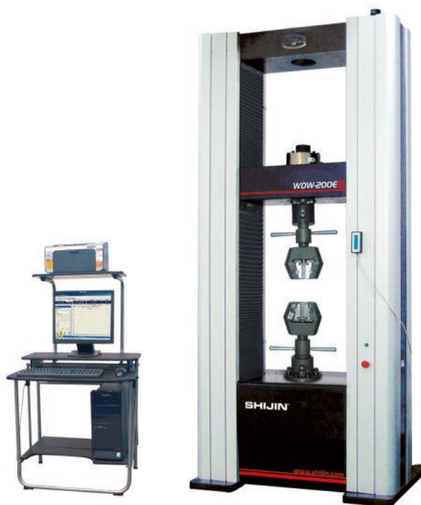
Figura 39 – Máquina Universal de Ensaio da Shijin WDW-100E III. Fonte: Catálogo da Time Group Inc.
