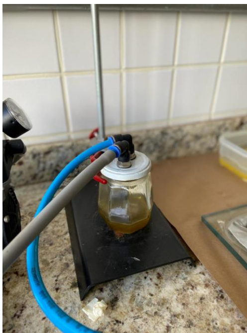
Figura 29 – Separador de resina.
