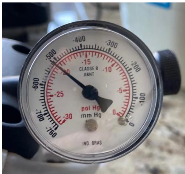
Figura 31 – Manômetro da bomba.
