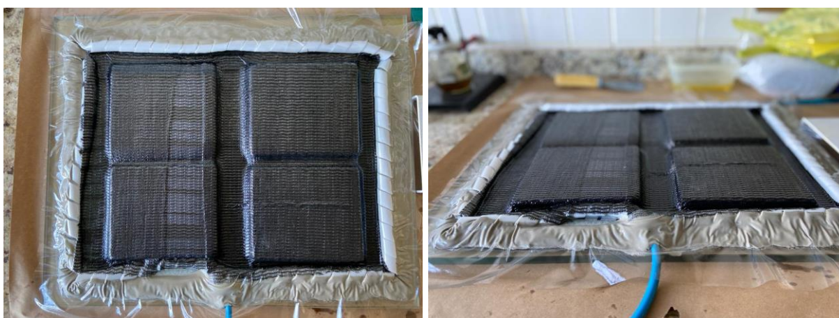
Figura 34 – Laminação a vácuo.
