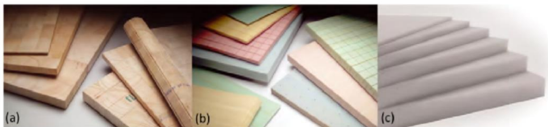
Figura 5 – Núcleo de madeira balsa (a), espuma de PVC (b) e espuma de PET (c).
