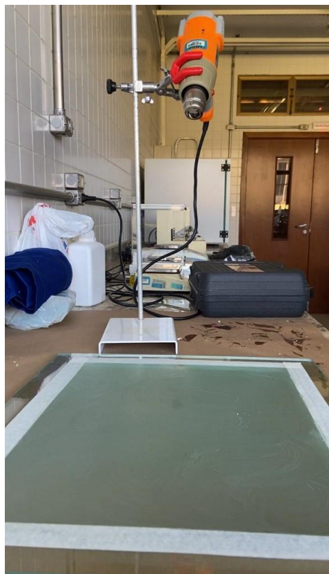
Figura 19 – Molde com 5 aplicações de cera.
