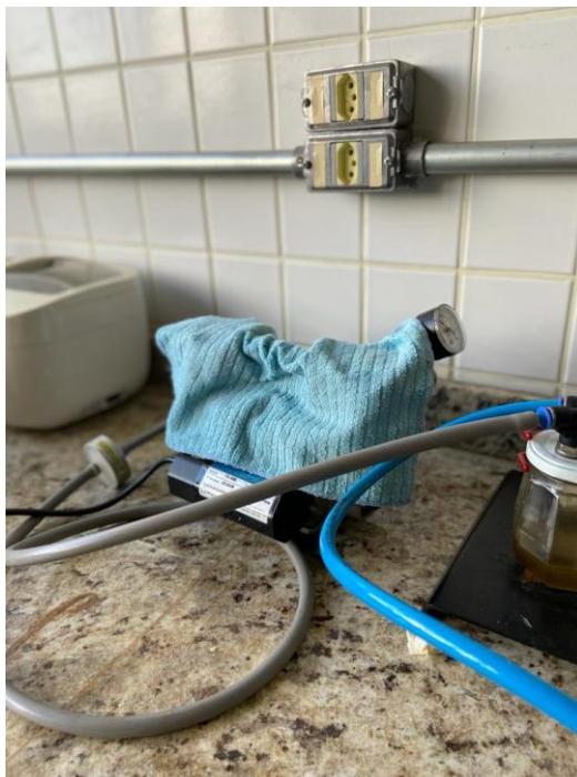
Figura 32 – Bomba coberta por um pano molhado.
