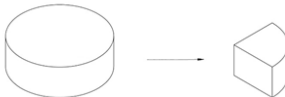
Figura 19 - Esquema do corte realizado nas amostras a serem embutidas.
