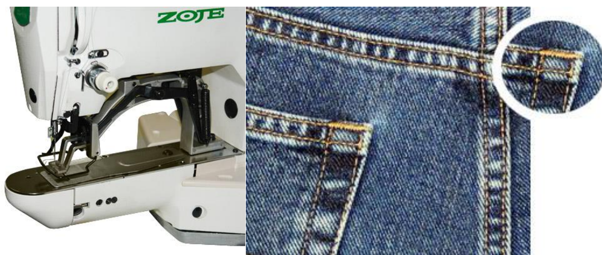
Figura 23: Máquina Travete e sua costura de acabamento terminal
