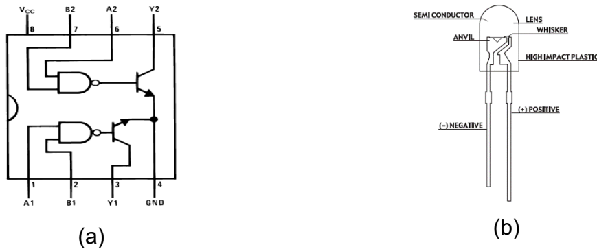
Figura 18: Estão representados em (a) Circuito driver de corrente com alta velocidade de chaveamento SN75451 e em (b) LED de alto brilho.
