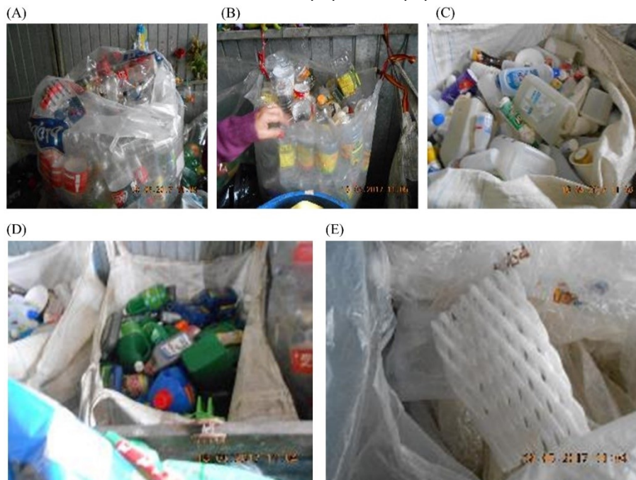
Figura 12 – PET transparente de refrigerantes (A) e óleo (B), PEAD branco (C), PEAD colorido (D) e PP (E)
