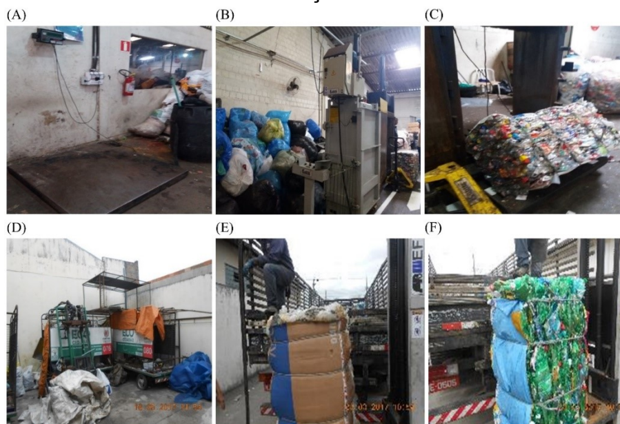
Figura 4 – Balança eletrônica (A), prensas verticais (B e C), carrinhos elétricos quebrados (D) e fardos feitos sendo carregados pelo comprador (E e F) no barracão da associação ACUBA
