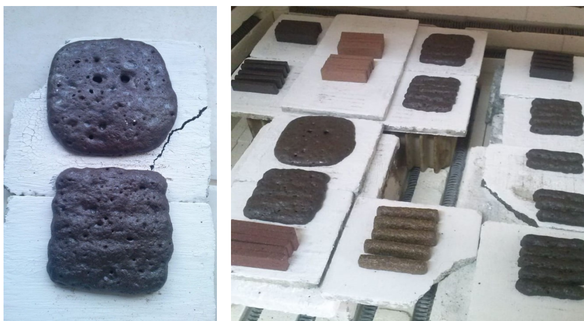
Figura 36 - Compósitos derretidos no forno na temperatura de 1200°C
