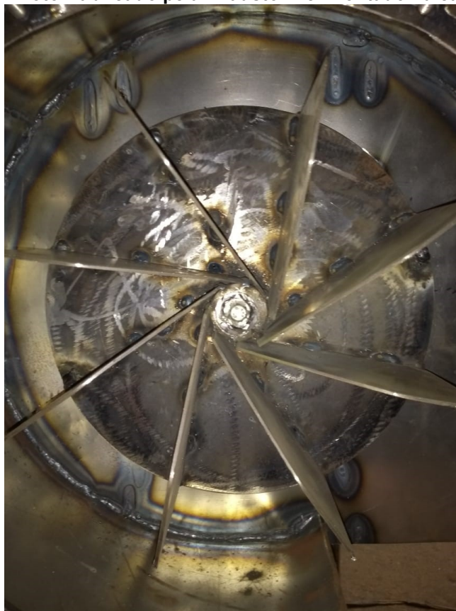
Figura 20 - Rotor fabricado pela Exaustor Bel montado na caixa espiral
