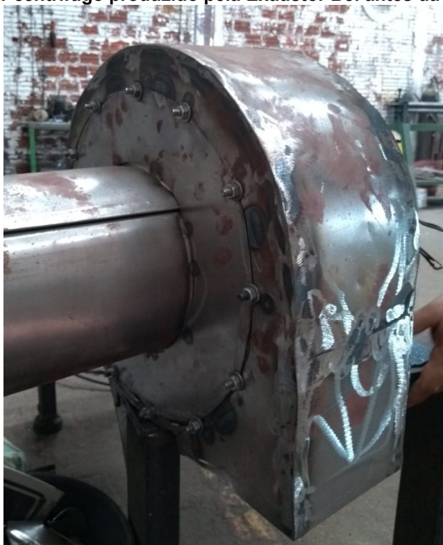
Figura 19 - Ventilador centrífugo produzido pela Exaustor Bel antes da etapa de acabamento
