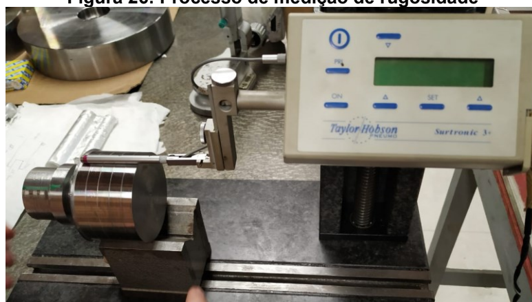
Figura 26: Processo de medição de rugosidade
